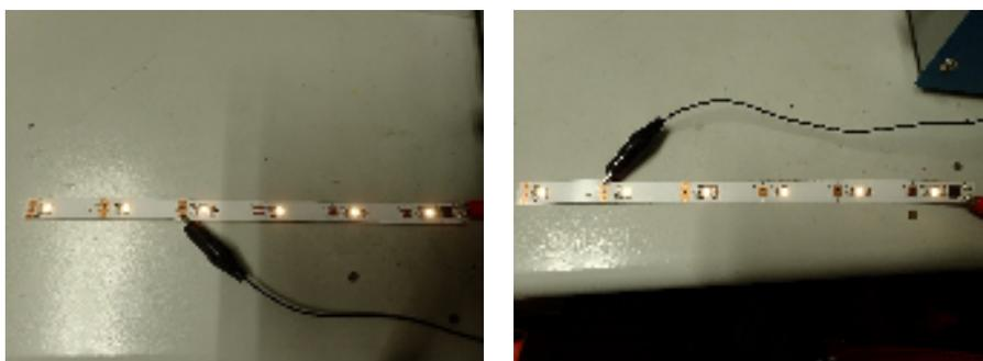
3. ハサミマーク・✂の部分で切り接ぎして使うことが出来ます。接ぐ場合は電極を半田付けします。
